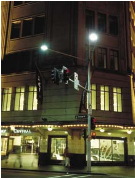
シティ中心部のマルチファンクションポール灯
