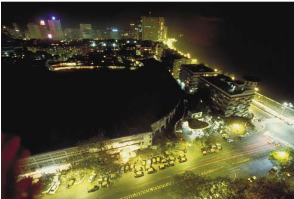
マリンドライブの交差点。従来のナトリウムランプを使ったオレンジ色のあかりと対照的に交差点部分はメタルハイドランプで白く照らされている
