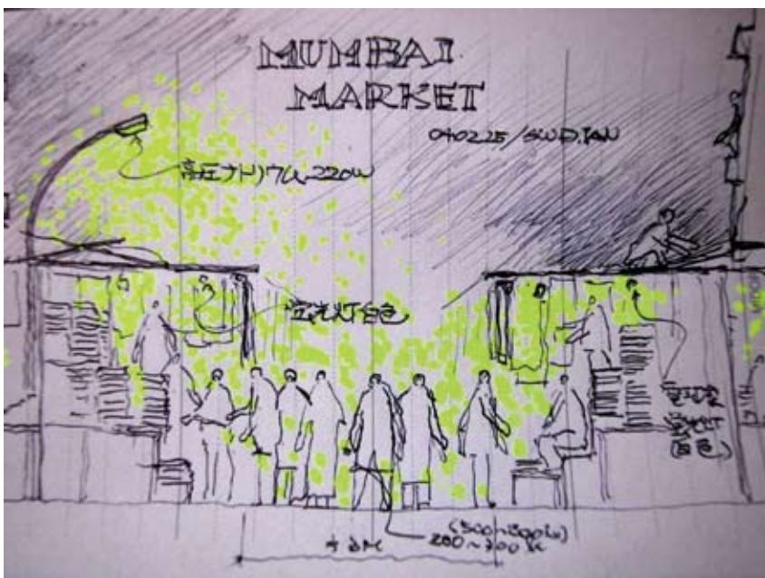
マーケットの断面スケッチ。通りの中央、地面レベルで500ルクスを確保している
