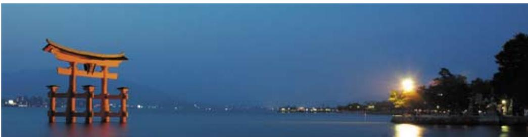
大鳥居：水銀灯2灯とナトリウム灯4灯の混光照明、50mほどの距離から照らされている
