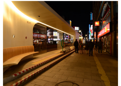
札幌市電停留所の間接照明が歩道照明としての役割を兼ねている。
