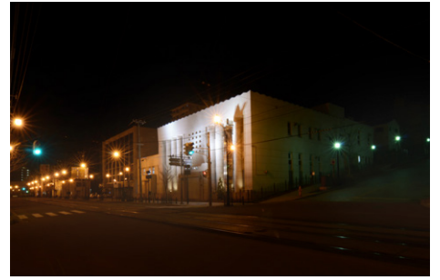
坂道は水銀灯の緑色、交差する市電の走る通りはナトリウム灯のオレンジ色。色温度がはっきりと計画されている。
