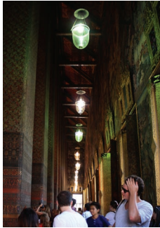
人の歩く空間は白色の蛍光灯、金色の大仏を照らすには色温度の低いメタルハイドランプ、真珠色の象嵌が施された大仏の足裏には色温度の高いメタルハイドランプ。器具の設置は無造作ながらも、光源の選定に明らかな配慮があり、大仏の存在感が演出されていた。
