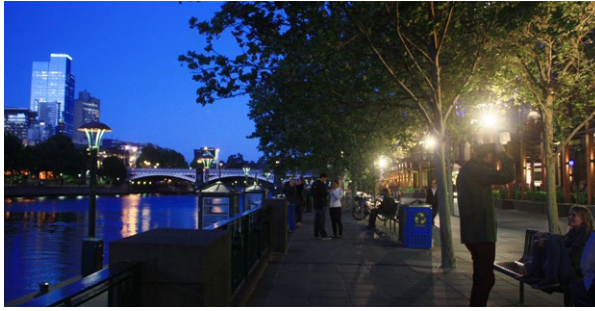
遊歩道沿いのポール灯自体は配光制御されており、樹木を照らす眩しいスポットライトも演色性は高く、照明器具をポールにまとめるという意匠性も計画的なのだが…。
