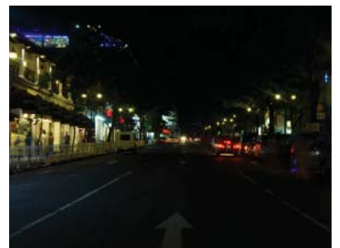
目抜き通り。車道用の街灯はなく、路面は1Lux程度の明るさ。
