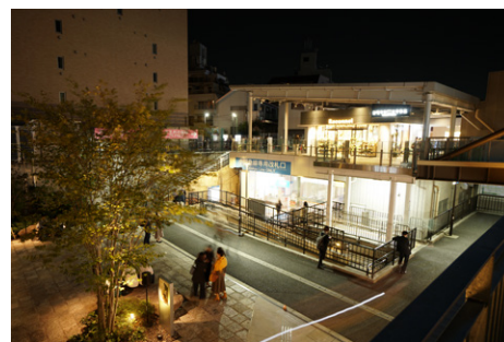
商業エリアと駅舎での色温度の違いが分かる
