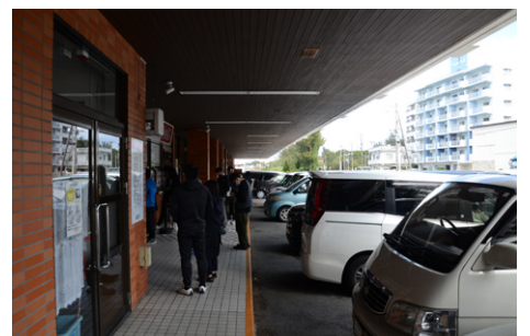
室内に届く強い日差しをカットするため、軒を長く設計した建物(シーサイドドライブイン)
