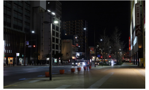
5mの高さの街路灯が歩道では用いられ、交差点のところではファサードをアップライトする照明が載っている
